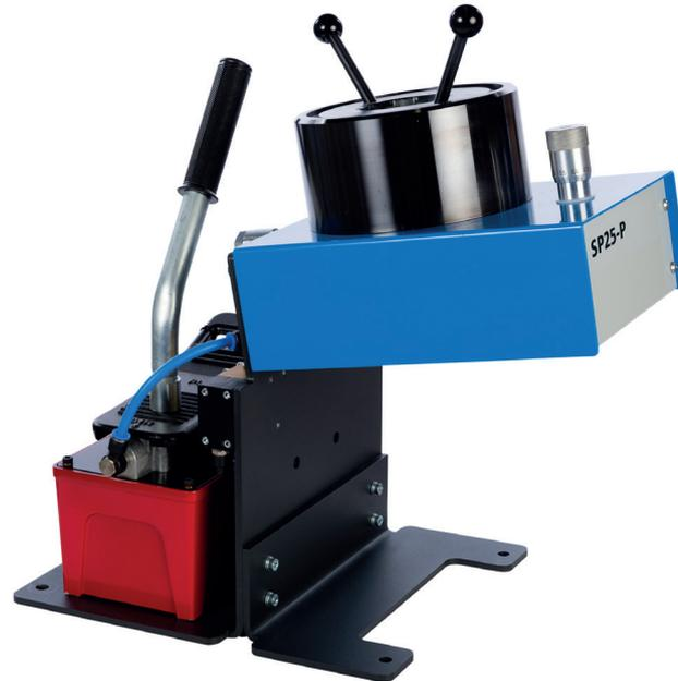
Gleitflächen der Pressbacken sind regelmäßig zu reinigen und zu schmieren.
